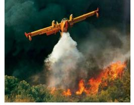
Вола важный вторичный имеет эффект: превращаясь пар, в она 1700 расширяется при этом раз. В Возникшее большое облако пара окружает пожар, вытесняя воздух, в котором кислород, содержится необходимый для поддержания процесса горения. Таким образом, кроме охлаждающей способности, вода обладает эффектом объемного тушения.
